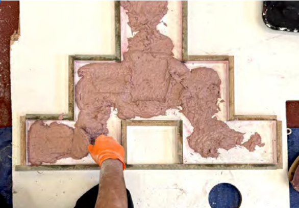
MIX POUR + SETTING cement . sand . aggregate . dye
